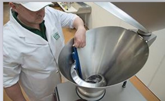
Colocación del rascador
