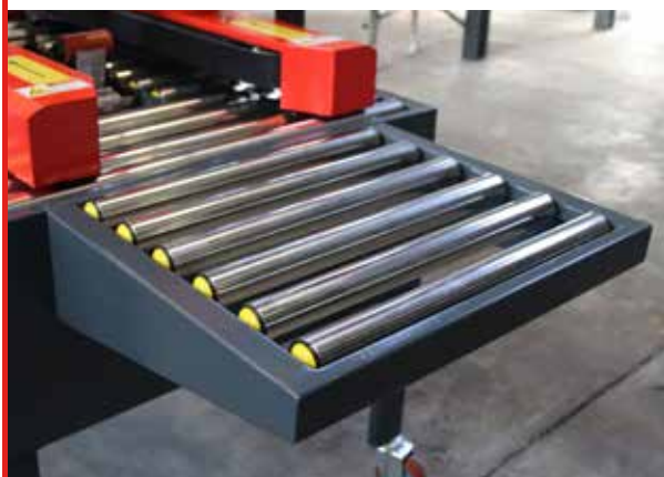
Camino de roldanas de salida/entrada
