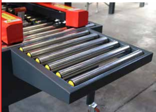
Camino de roldanas de salida/entrada
