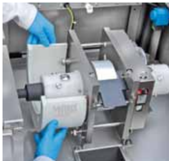
Quitar el depósito evaporador para limpiar manualmente
