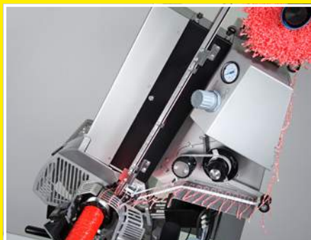
El dispositivo automático de cordel GSE está montado en la parte derecha de la máquina.
