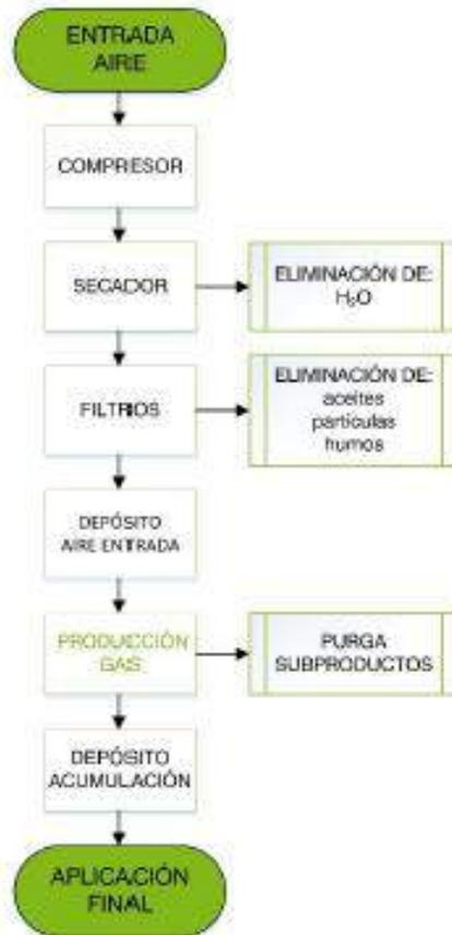
Figura 2: Diagrama de flujo del proceso de producción de los equipos.
