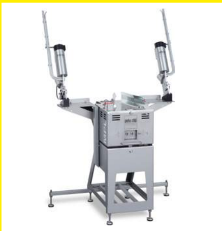
MPL con bastidor y grapadoras de una sola grapa EZ 4500 para diestros y zurdos
