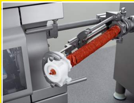
Asistente de freno de tripa - soporte semiautomático de freno de tripa
