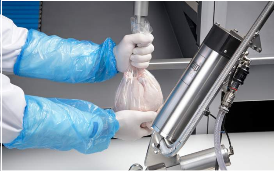
Boquilla de vacío vertical (boquilla de aspiración) en combinación con la máquina grapadora EZ 600 de la Easy Clip Line®
