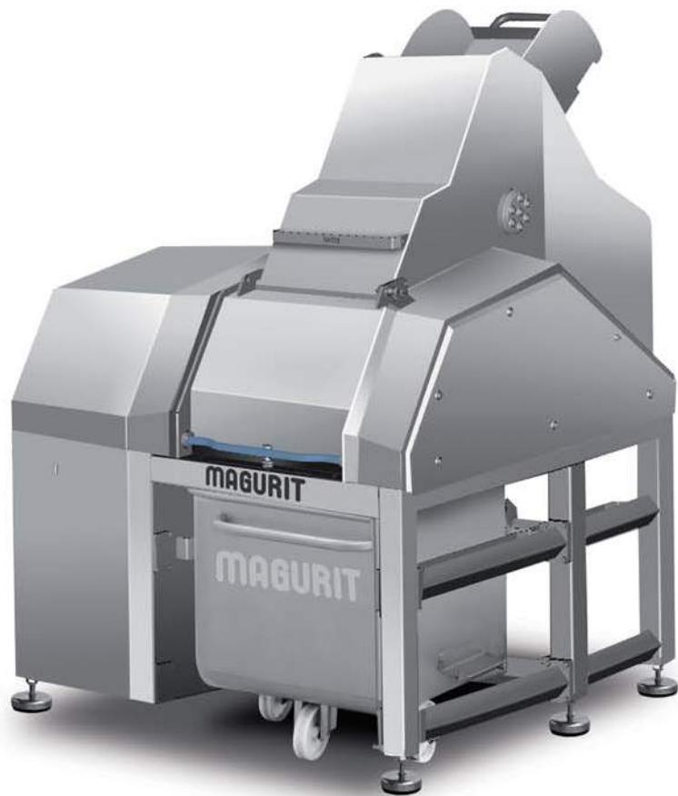
Le STARCUTTER 312 est une machine pour les petites et moyennes productions avec une capacité journalière de 6 à 8 Tonnes. La machine est conçue pour des blocs Euros et US. La zone de découpe est située au-dessus du tambour. Les blocs glissent du haut vers le bas, ils sont entraînés par la rotation du tambour avec une épaisseur de coupe de 6 à 20mm. Le produit grignoté tombe dans un bac 200 Litres qui peut être positionné de 3 côtés différents.
