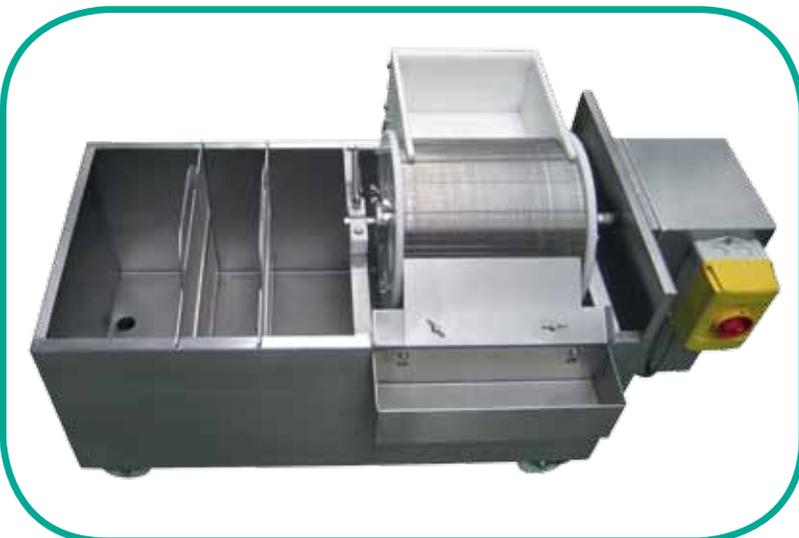
Para mantener la salmuera circulante libre de partículas, cada inyector puede adicionalmente ser equipado con un filtro rotativo y dos filtros adicionales. Adicionalmente se puede utilizar un filtro en línea.
