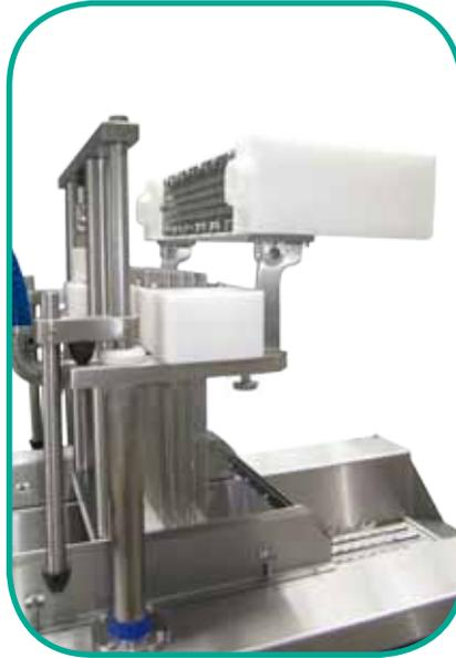
El sistema de suspensión neumática de las agujas es individual y se puede ajustar proporcionalmente. Todas las agujas se pueden quitar fácilmente para la limpieza sin necesidad de herramientas. Ofrecemos diversos tipos de agujas en 4, 3 o 2,5 mm con el fin de satisfacer las diferentes necesidades según los productos.
