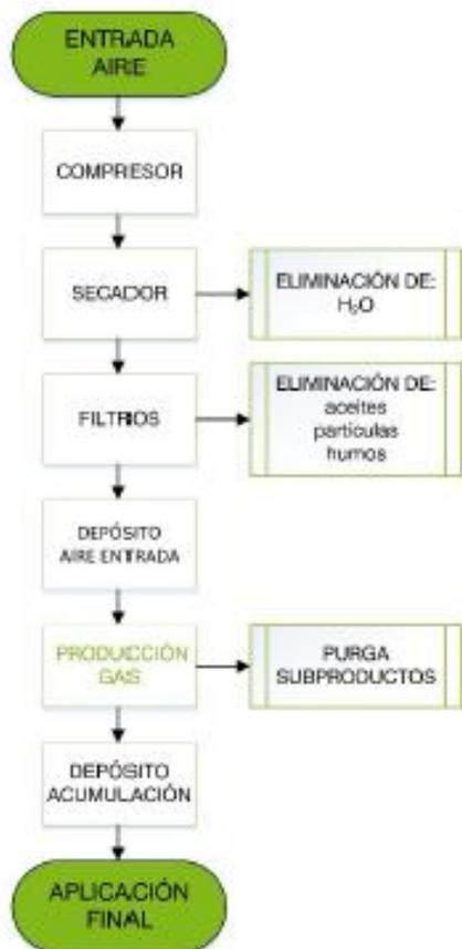
Figura 2: Diagrama de flujo del proceso de producción de los equipos.
