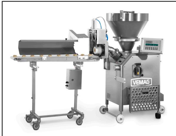
Separador de masa Robot 500 con dispositivo de corte neumático 811
