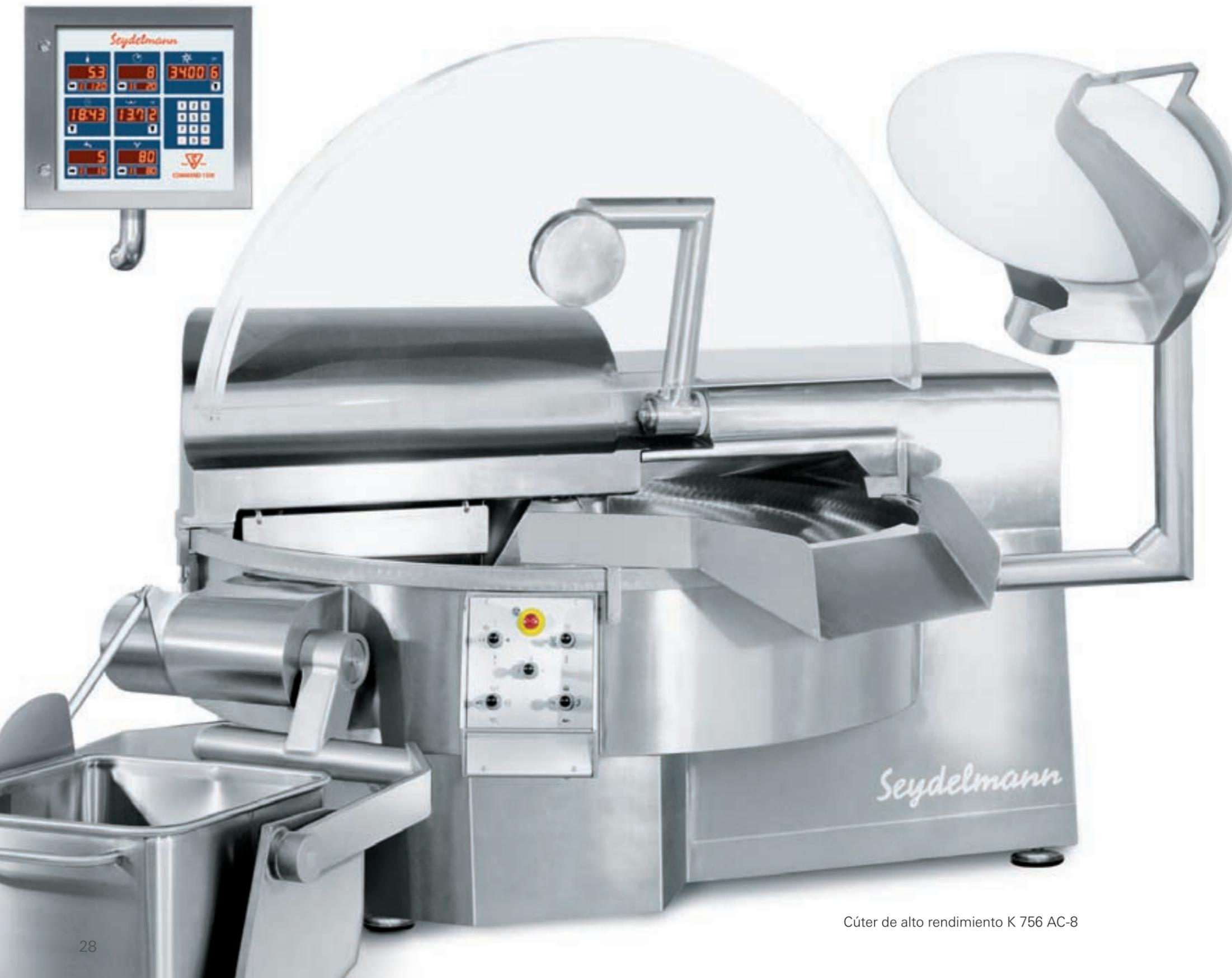
Para el emulsionado de la pasta, se programa una velocidad de cuchillas más baja. Mediante la adaptación de la velocidad durante la fase de emulsión a cada receta se obtiene una consistencia más sólida. La acción conjunta de todas estas características incrementa, sobre todo, la calidad óptica del embutido. Un embutido más atractivo y que despierta el apetito aumenta la disposición a su compra.
