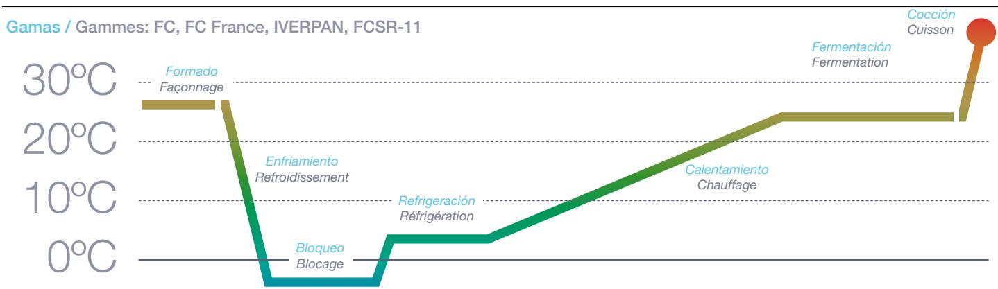
La fermentación controlada permite al profesional artesano racionalizar sus horarios de producción. Una bajada de la temperatura a -1°C, bloquea toda actividad enzimática. Una correcta parametrización de temperatura y grado de humedad, junto con un diseño óptimo de cámaras, evita la condensación en el producto, dando como resultado un pan fresco y aromático.
