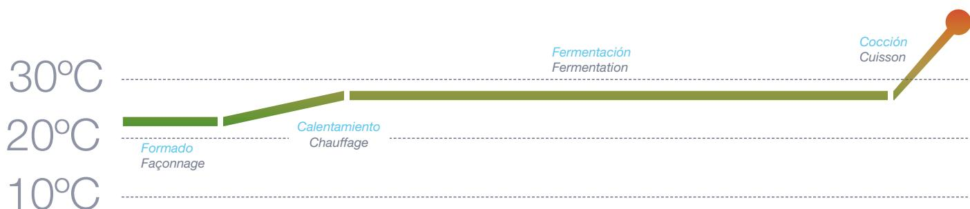
Tras alcanzar la T<sup>a</sup> optima de fermentación (26-28°), esta se mantiene constante durante todo el proceso, así como los porcentajes de humedad (70-82%). En estas condiciones se da un equilibrio entre procesos fermentativos y ácidos.
